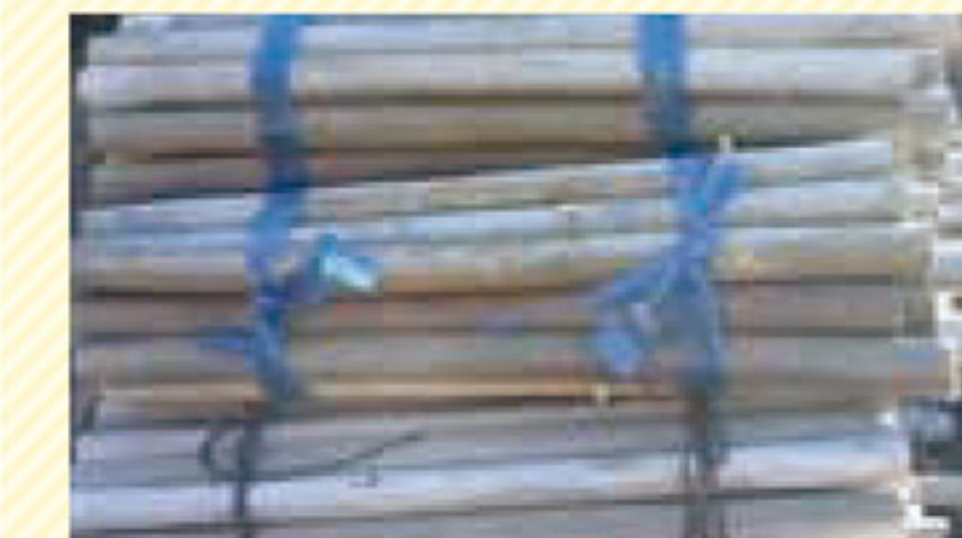
塩ビパイプ 1mに切断し、2ヶ所結束
