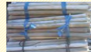
塩ビパイプ 1mに切断し、2ヶ所結束
